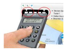
Halten Sie das Gerät mit der Rückseite vor die blinkenden Felder Ihrer Banking-Anwendung, bis das Gerät "Übertragung erfolgreich" anzeigt.
