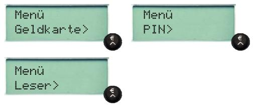
Mit Hilfe der Pfeiltasten können Sie durch das Konfigurationsmenü navigieren. Mit der C-Taste verlassen Sie jederzeit das Konfigurationsmenü, mit der OK-Taste wählen Sie den aktuellen Menüpunkt aus.
